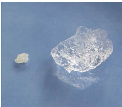
شکل ۱- پلیمر سوپرجاذب قبل (چپ) و بعد از جذب آب (راست)
